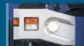
ブーム先端の左右に被視認性を高める高輝度のLEDライトを装備しています。
